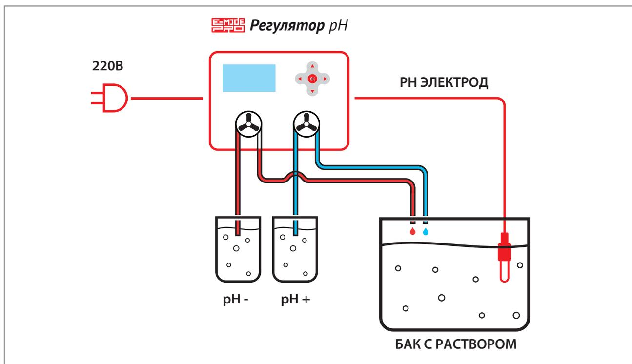
**ВНИМАНИЕ!** В качестве реагентов (кислота pH down, щелочь pH up) разрешено использовать 20% - 30% растворы. Более концентрированные реагенты приведут к выходу прибора из строя!
